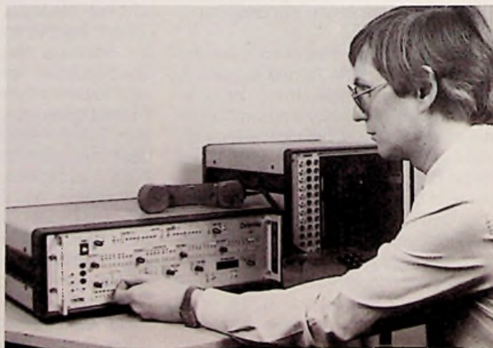
Bild 16: Schnittstellensimulator für EWSD-Baugruppen (DeTeWe-Pressbild)
