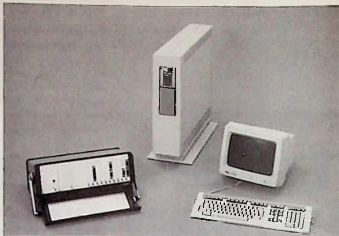
Bild 14: ISDN-Simulator für D-Kanal-Protokoll (SEL-Pressbild)
