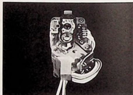
Bild 2b: Optischer Abtaster aus eigener Entwicklung (Thomson-Brandt-Pressbild)
