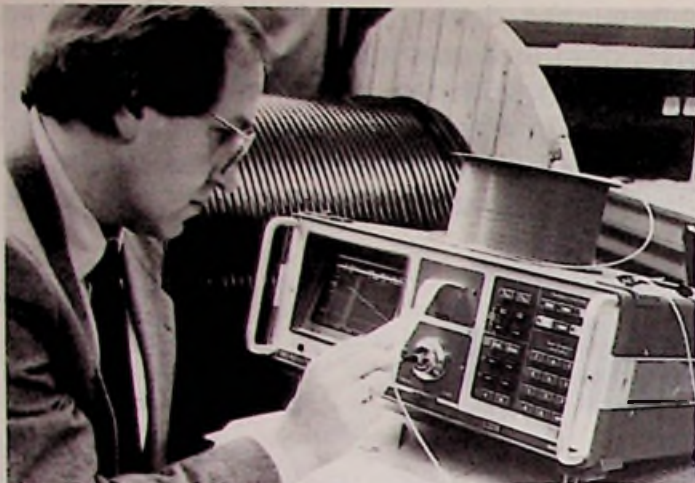
Bild 13: Reflektometer für komfortable Messungen an Lichtwellenleitern (Siemens-Pressbild)
