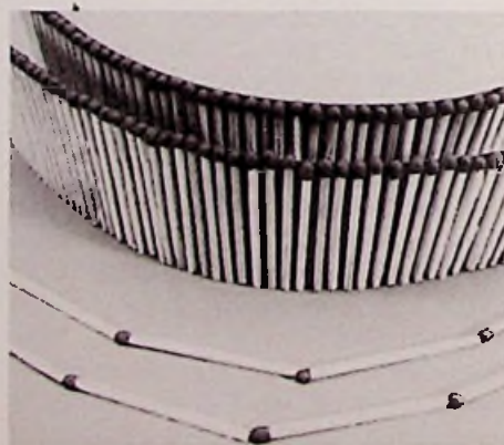
Bild 1: Demonstrative Darstellung des Unterschiedes zwischen Längsspur- und Vertikalspur-Aufzeichnung (3M-Pressbild)
