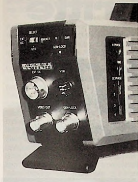
Bild 9: Das rückwärtige Anschlußfeld mit den seitlich angeordneten Justierelementen für die H- und SC-Phase bei Genlock-Betrieb
